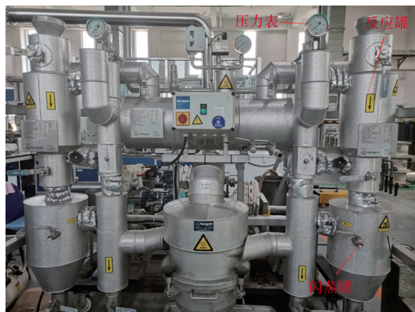
图1 试验用热水解装置
