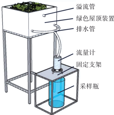
图1 简单式绿色屋顶试验装置
