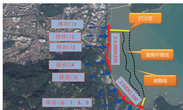
图3 香炉湾沙滩修复雨水排放口改造总体方案
