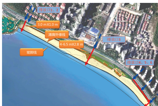
图4 凤凰湾沙滩(美丽湾段)修复雨水排放口改造总体方案
