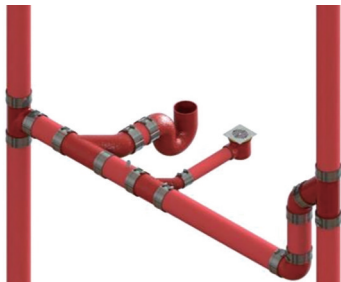
图 1 实验层排水系统安装形式
