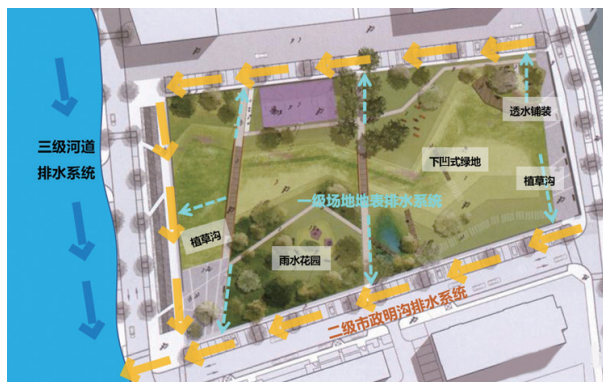
图3 浅表流三级排水系统示意
