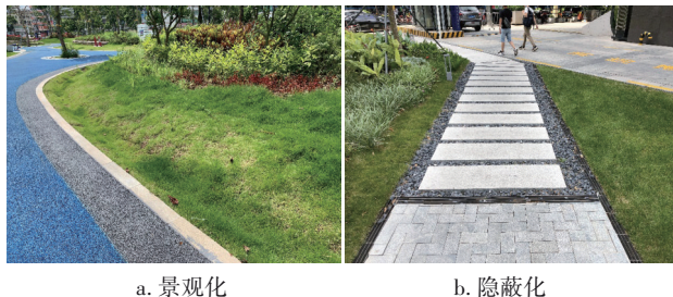
图5 浅表流排水系统景观化、隐蔽化处理示意
