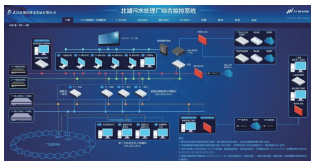
图3 调度中心生产监控系统网络拓扑结构
