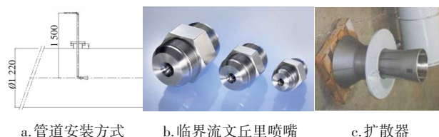
图3 “气/液”管道混合投加装置
