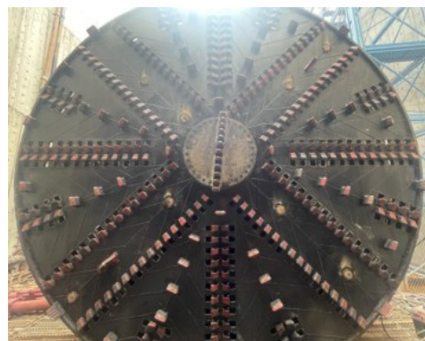
图1 顶管机刀盘结构
