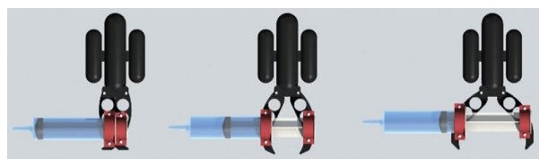
图4 水样采集器和机械臂组合的设计模型(3种行程)
