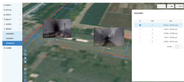
图6 管线缺陷图片信息
