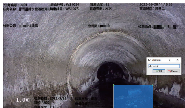
图2 排水管网缺陷信息标注
