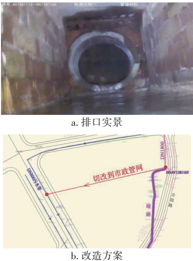
图4 污水大口径排水口改造方案
