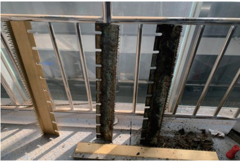
图6 挤条机铜梳锯齿被垃圾缠绕
