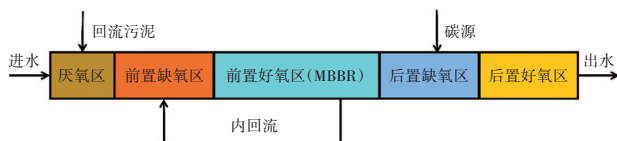
图1 MBBR工艺流程
