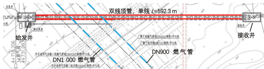
图1 顶管施工平面
