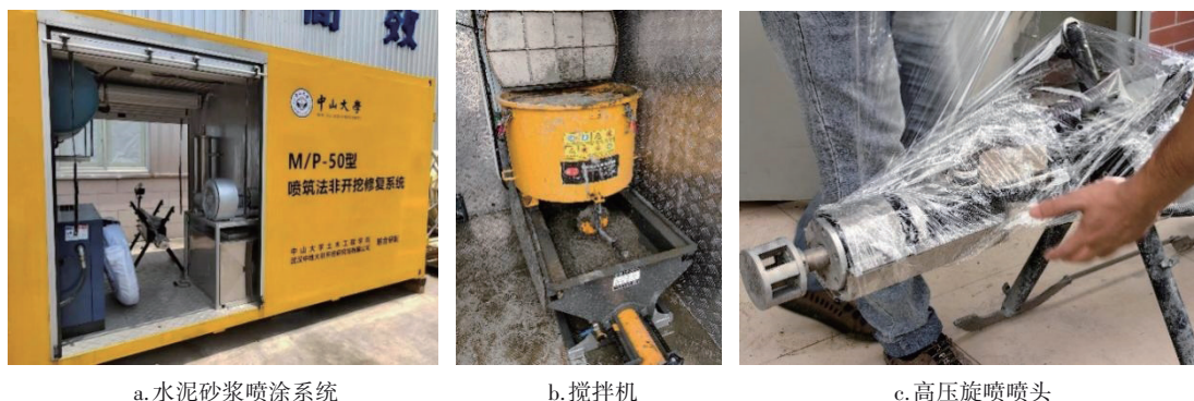
图6 管道喷涂系统
