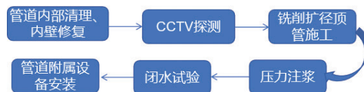
图1 管道修复技术路线
