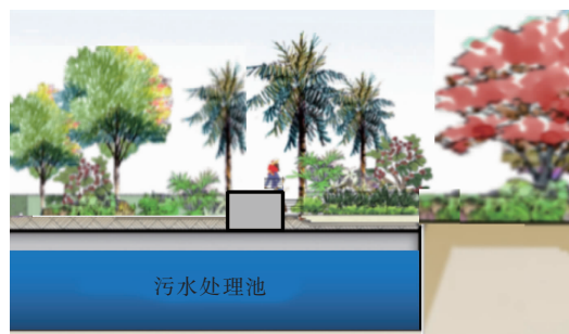
图2 地埋式污水处理厂示意图
