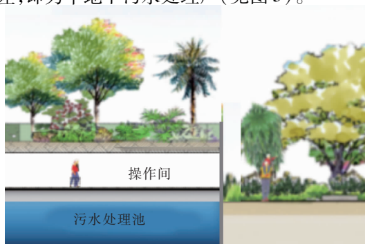
图5 半地下污水处理厂示意图
