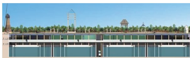
图1 地下式污水处理厂典型竖向布置
