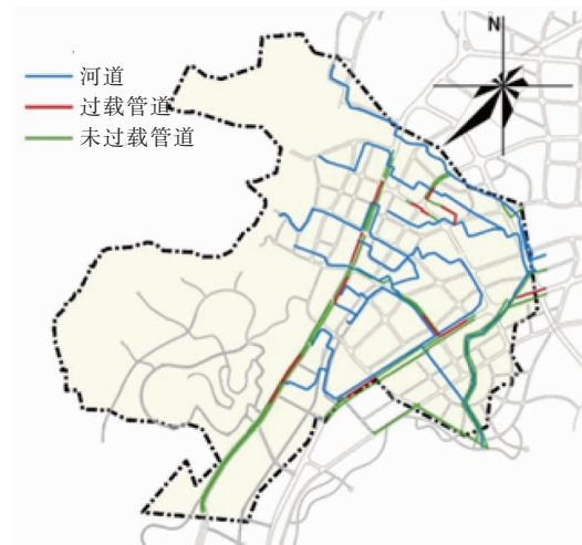
图1 一维管道排水能力评估
