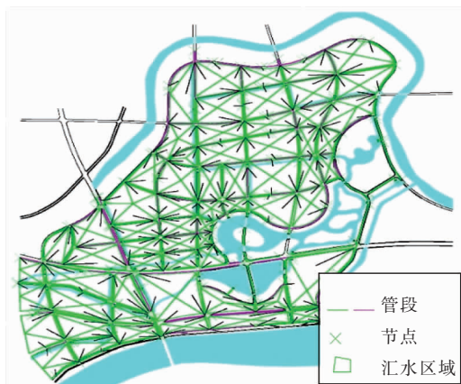
图3 研究区域的 AutoCAD 模型
