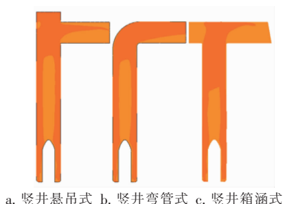
图9 出水管压力分布云图
