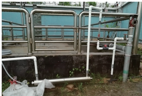
图1 预紫外试验装置
