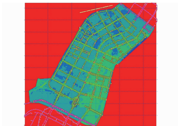
图2 红谷滩中心区管网、地形及河道耦合模型
