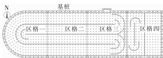
图1 氧化沟底部平面布置
