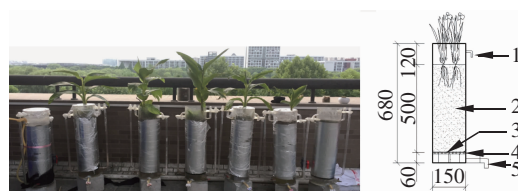
1.溢流管 2.渗滤介质 3.土工布 4.多孔板 5.软管
