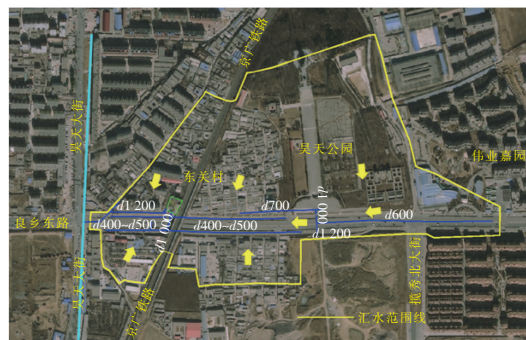
图3 现状下凹桥区排水系统布置
