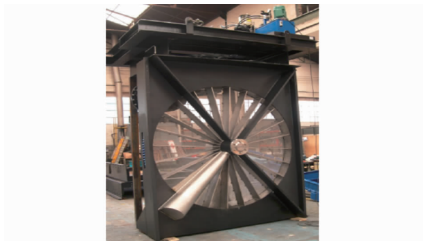
图3 WIP 旋转滤网结构
