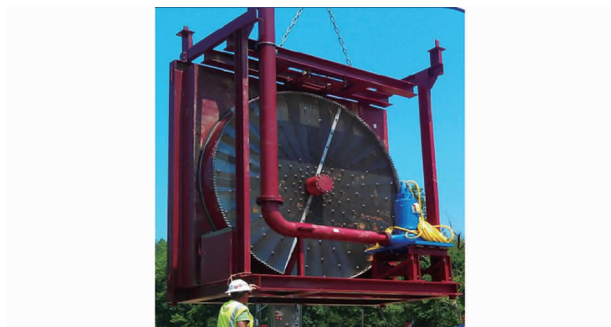
图4 WIP 旋转滤网专用鱼类输送泵及洄游管道
