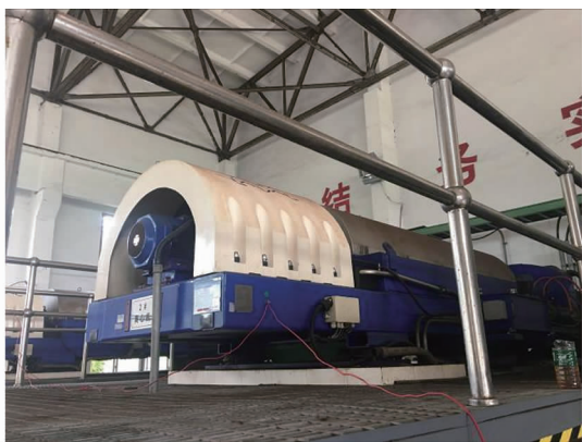
图 1 离心机系统现场安装
