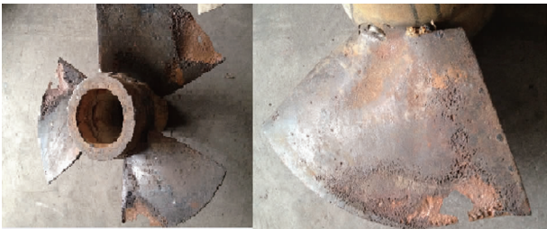
图 2 发生汽蚀破坏的叶轮
