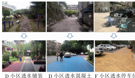
图2 D、F小区改造前、后下垫面实景对比
