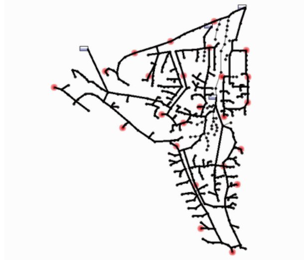
图5 案例一爆管监控网络测点位置与被监控管线( n=24 , S_n^2 = 0.8051 )
