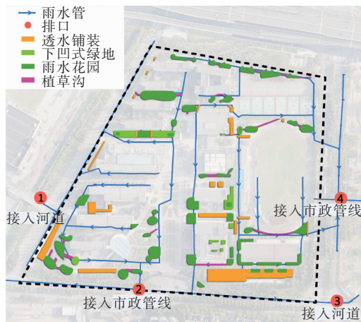
图1 雨水管网及 LID 设施布置
