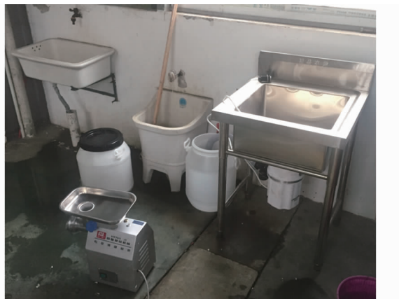
图1 破碎厨余垃圾测试装置实景
