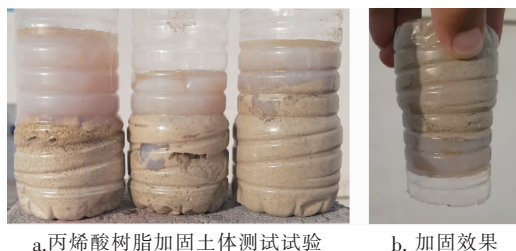
图3 ACRYL - X1000 丙烯酸树脂加固土体测试及结果
