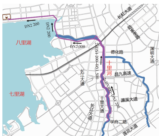
图1 排水管道非开挖修复案例
