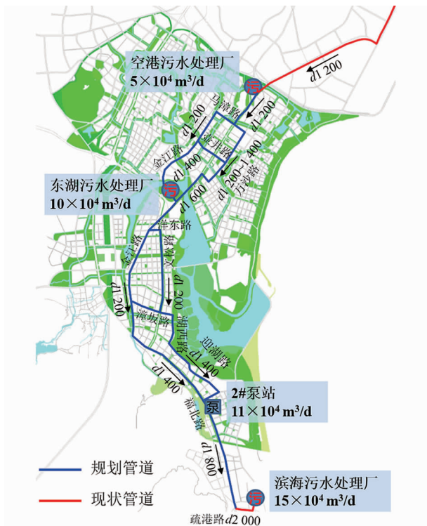
图3 滨海新城核心区污水干管布置
