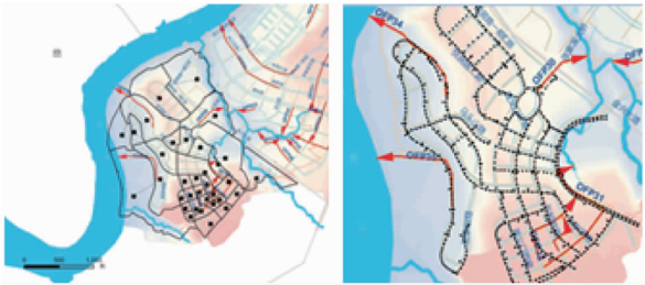
图 2 模型汇水区划分和管网搭建
