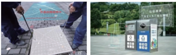
图7 井盖倾斜、垃圾桶超重满溢自动报事
