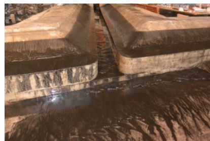
图8 Y型明渠水力模型淤积情况
