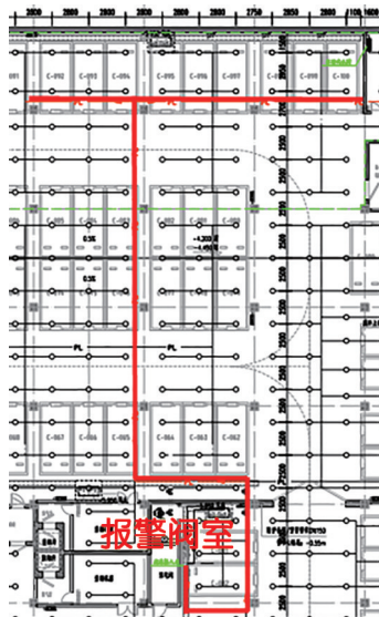
图 5 地下车库泡沫-水喷淋布置
