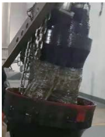
图2 塑料类垃圾缠绕电机
