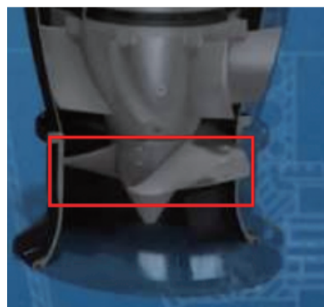
图4 方案一:拆除进水口耐磨环
