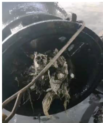
图1 大量垃圾堵塞叶轮通道
