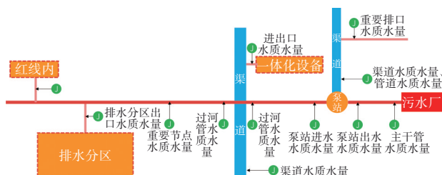
图1 排水系统流量、水质监测体系构建示意
