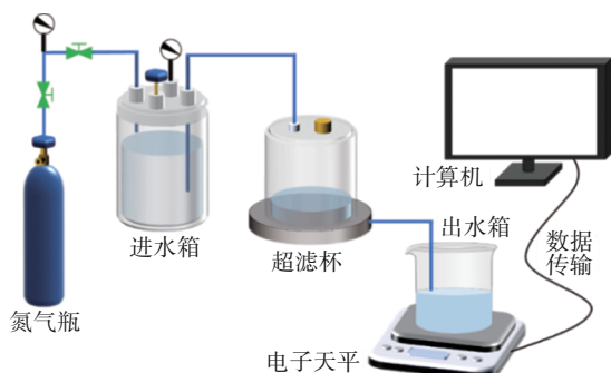
图1 超滤试验装置
