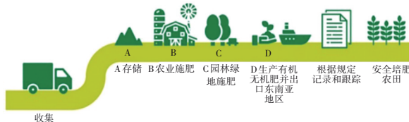
图6 GrønnVekst公司污泥资源化技术路线
