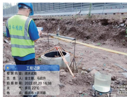
图 5 改进型闭水试验装置在工程中的应用
