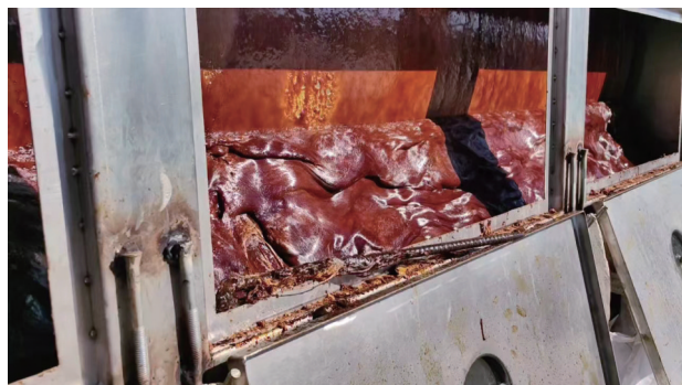
图2 正在出料的刮板滚筒干燥机
