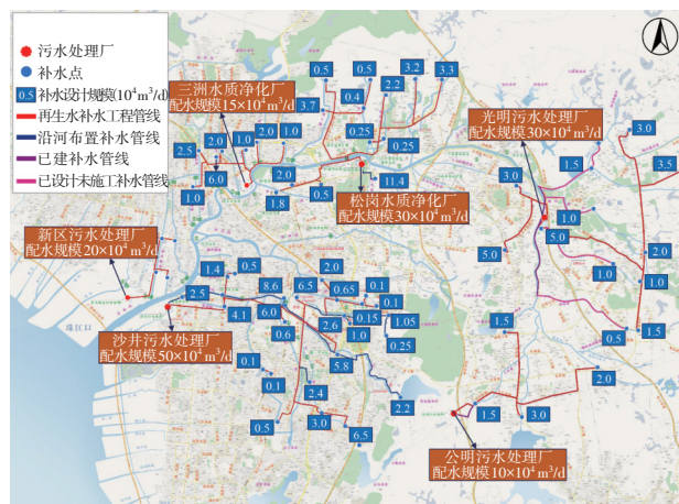
图9 茅洲河流域再生水补水线路及规模平面布置
