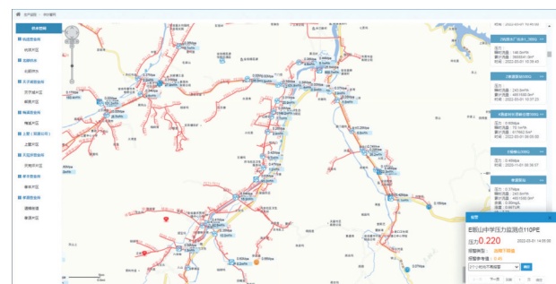
图3 生产监控系统嵌入管网GIS数据
