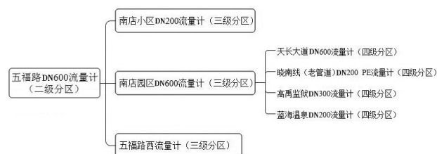
图5 五福路DN600主管区域DMA分区
