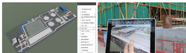
a. 轻量化模型开展施工时序计划演示 b. 基于 AR 的现场和实际进度对比
