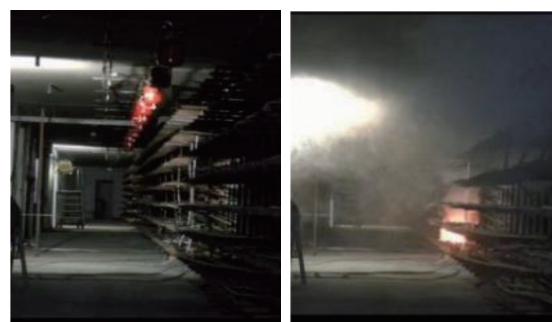
a. 通电10 s后电缆阴燃产生烟气
