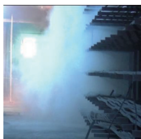
c. 高压细水雾系统启动后灭火
