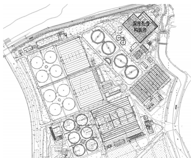
图2 提标后深度处理构筑物的平面布置
